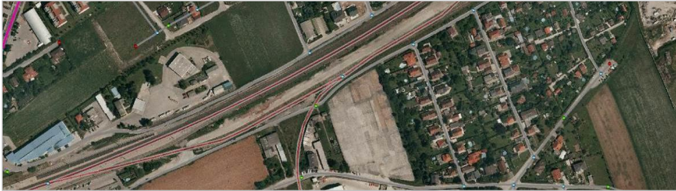
Abb. 147: Beispiel einer Anschlussbahn die vom Verbindungsgleis abzweigt
