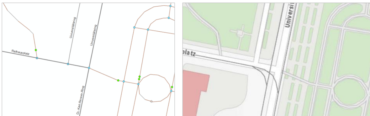
Abb. 1: Das routingfähige Knoten-Kanten-Modell (links) und kartographische Darstellung (Basemap.at, rechts).
